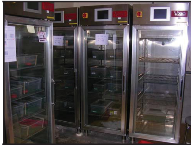
Figure 10. Enceintes climatiques permettant le contrôle des conditions thermiques et hydriques journalières
