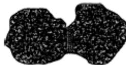
Figure 4: Pont solide entre deux grains [9]
