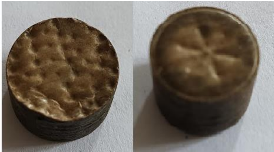
Figure 12 Bourre grasse en feutre vue par la face sèche et la face grasse
