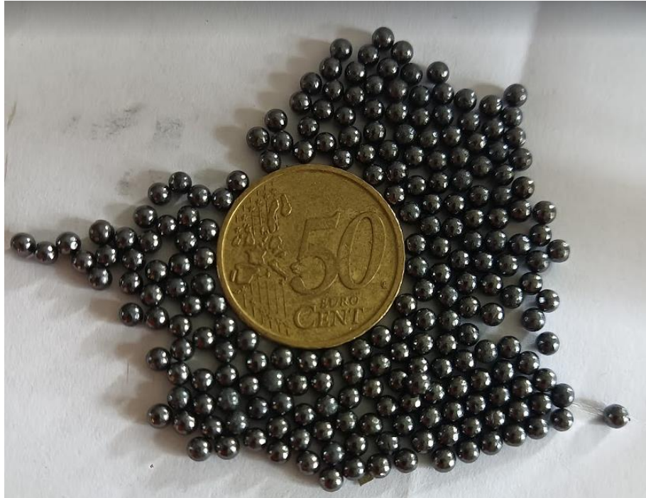
Figure 11 Plombs de Numéro 5 récupérés dans une cartouche de Calibre 12 de charge 36 g
