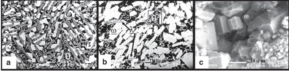
Fig. I.16. Images MEB d'alliages de composition nominale  $\text{Al}_{70}\text{Cu}_{20}\text{Fe}_{10}$  obtenus par coulée conventionnelle puis recuits à a) 873 K pendant 25 h, b) 873 K pendant 72 h, c) 973 K pendant 150 h (Rosas 2007).
