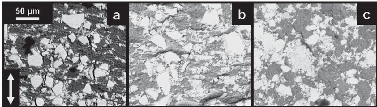
Fig. I.14. Images MEB, en contraste d'électrons rétrodiffusés, caractéristiques des composites Al/Al-Cu-Fe déformés à a) 473 K b) et c) 673 K (El Kabir 2007). La double flèche est parallèle à l'axe de compression.
