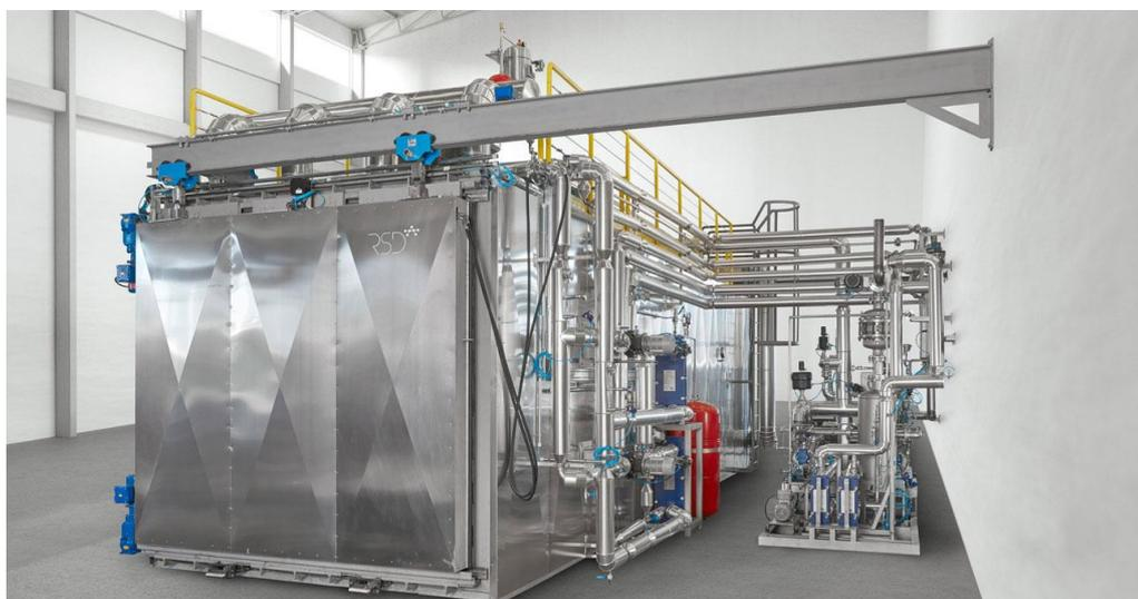
Figure 2: Chambre de stérilisation à l'oxyde d'éthylène (8)
