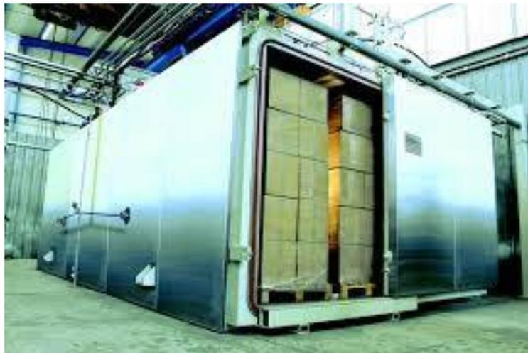
Figure 17 : Chambre de stérilisation avec palettes prêtes à subir le traitement (77)
