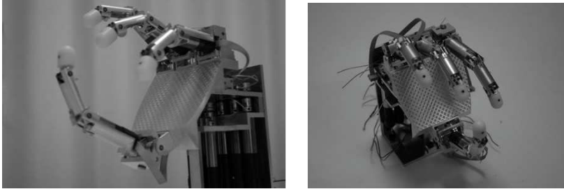
FIGURE 24: La main compacte à douze actionneurs et seize articulations ROB-H12
