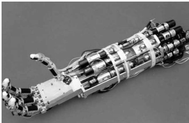
FIGURE 19: La main à quatre doigts et seize actionneurs ROB-H16
