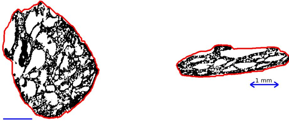
FIGURE 5.14 – Tomographie nettoyée et seuillée du résidu final. La ligne rouge correspond au contour détecté. Section perpendiculaire à la direction  $x$  (gauche) et  $z$  (droite). Deux échelles de pores sont visibles.
