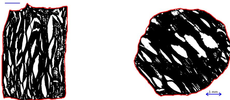
FIGURE 5.13 – Tomographie nettoyée et seuillée correspondant à l'échantillon intermédiaire. La ligne rouge correspond à l'enveloppe détectée. Section perpendiculaire à la direction  $x$  (gauche) et  $z$  (droite). Deux échelles de pores sont visibles, particulièrement sur la coupe à la direction  $X$ .
