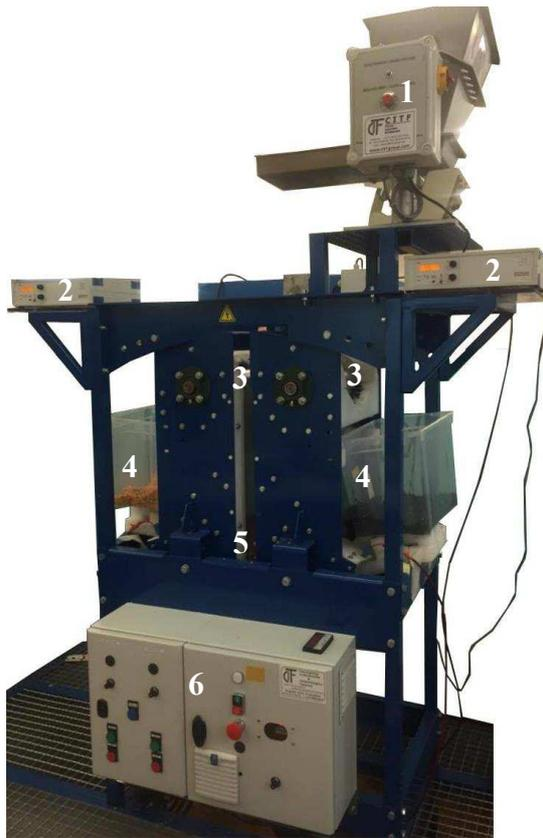
**Figure 1** : Séparateur tribo-aéro-électrostatique pour le recyclage des DEEE ;
