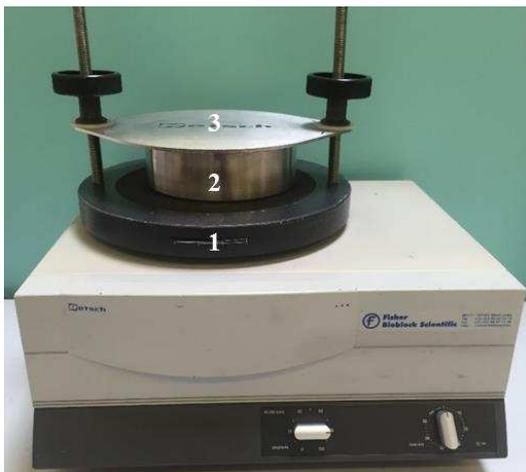
**Figure IV-2** : Dispositif de charge par vibrations « Tamiseuse » ; 1 : Plaque de base de la tamiseuse (amplitude des vibrations : 2 mm) ; 2 : Récipient en acier sur lequel la matière est préalablement déposée ; 3 : Couvercle en acier.
