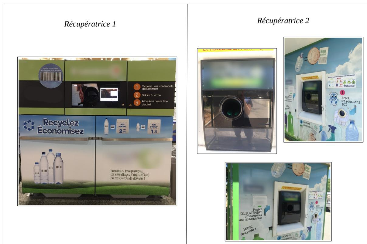
Figure 28 : Exemples de récupératrices de bouteilles plastiques
