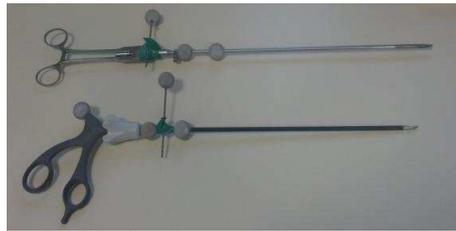
FIGURE 2.9 – Pince et porte-aiguille instrumentés avec des marqueurs réfléchissants
