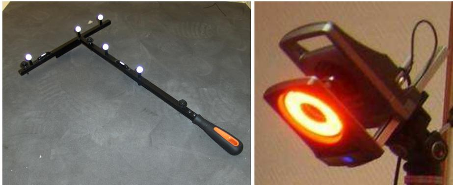
FIGURE 2.2 – Camera Vicon et baguette de calibration Wand
