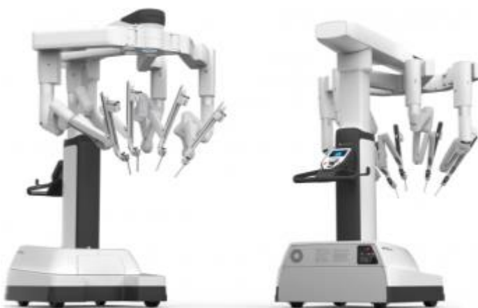
Figure 12 : chariot et bras du robot Xi
