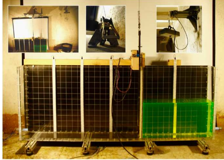
Fig 2.19 Configuration expérimentale du réservoir pour l'écoulement de la rupture de barrage proposée par Lobovsky et al. [Lobovskỳ et al. , 2014].
