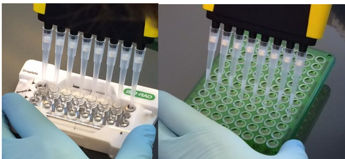
Figure 27 : Transfert des gouttelettes générées de la cartouche vers la plaque 96 puits à l'aide d'une pipette multicanaux.
