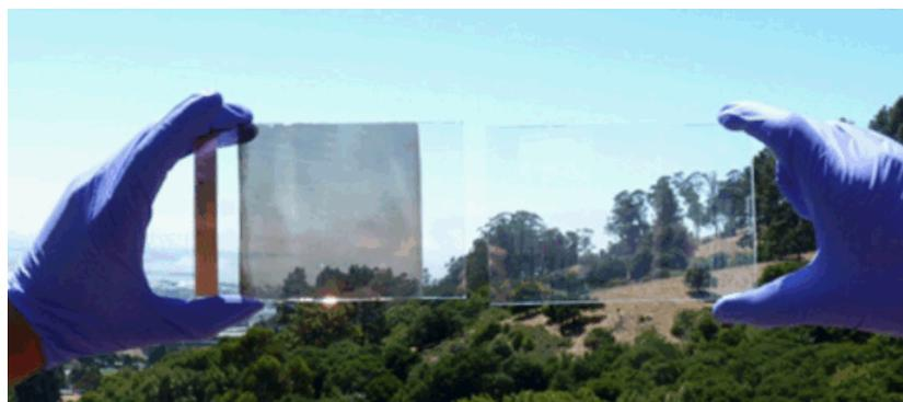
FIGURE 1.4 – Vitrage photochrome (<http://www.infohightech.com/une-vitre-plus-intelligente-et-meilleur-marche/>).
