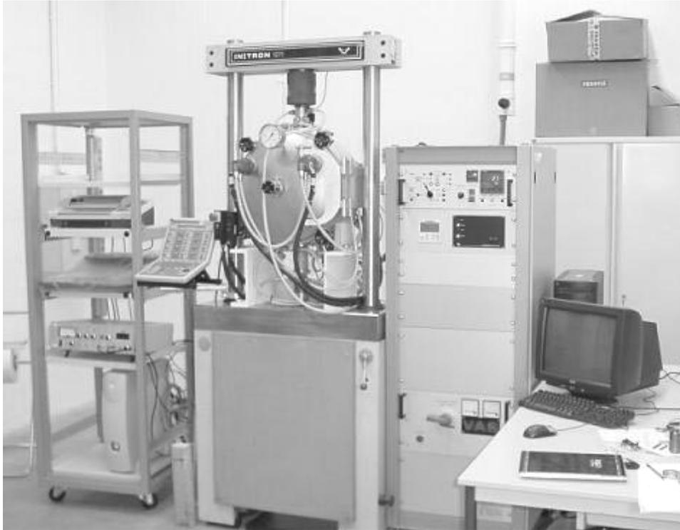
**Figure II-12. Machine de fatigue sous vide INSTRON 1271.**
