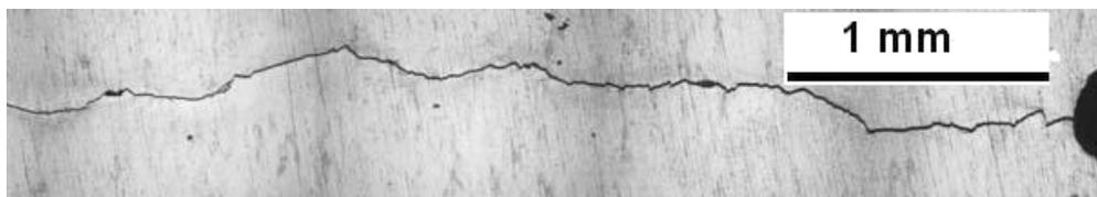
Figure III-25. Fissure de fatigue sous air. 10 Hz R=0.7 Sens L-T.  $K_{max} = 13.3$  à  $17.5$  MPa $\sqrt{m}$ .
