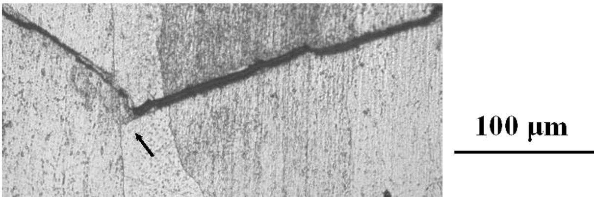
**Figure IV-19. Effet barrière d'un joint de grains (flèche noire). Ultravide. R=0.7. Sens L-T.  $\Delta K=8.4 \text{ MPa}\sqrt{\text{m}}$ . Propagation de droite à gauche.**
