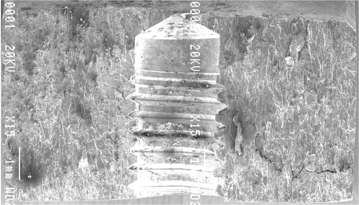
**Figure III-12. Rupture intergranulaire entre un trou de goupille et la face avant de CSC4.**
