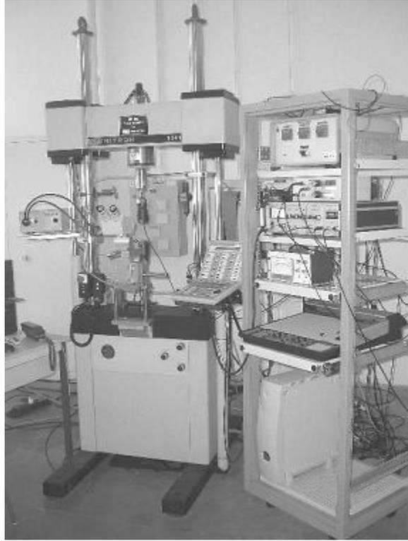
**Figure II-13. Machine de fatigue sous air INSTRON 1341.**
