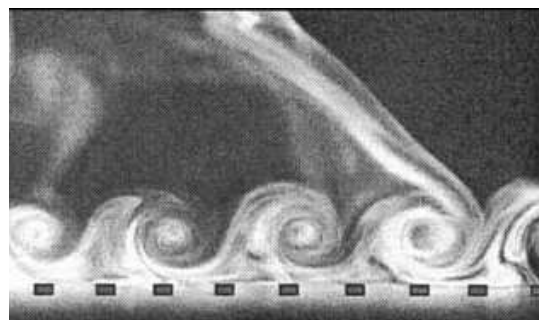
Figure 4.14. Visualisation des tourbillons générés par le réseau d'électrodes utilisé par Jukes et al. à deux instants différents.
