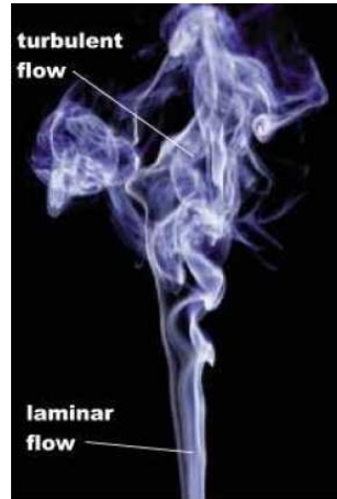
Figure 4.2. Visualisation de la différence entre un écoulement laminaire et un écoulement turbulent.
