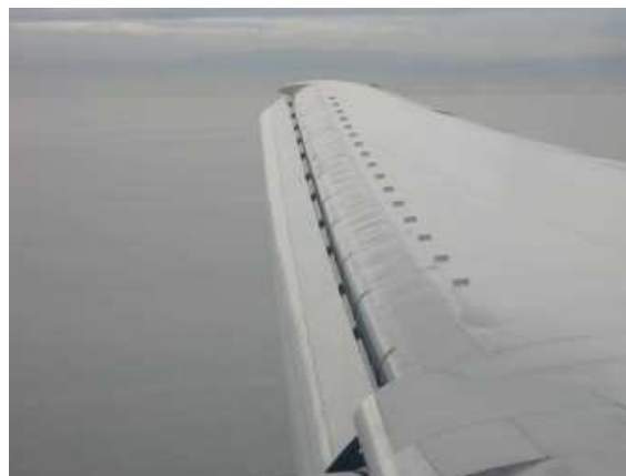
Figure 1. Schéma d'un profil d'aile avec bec de bord d'attaque et volets de bord de fuite (a) et photo d'une aile de Boeing 767 avec volet de bord de fuite sorti (b).
