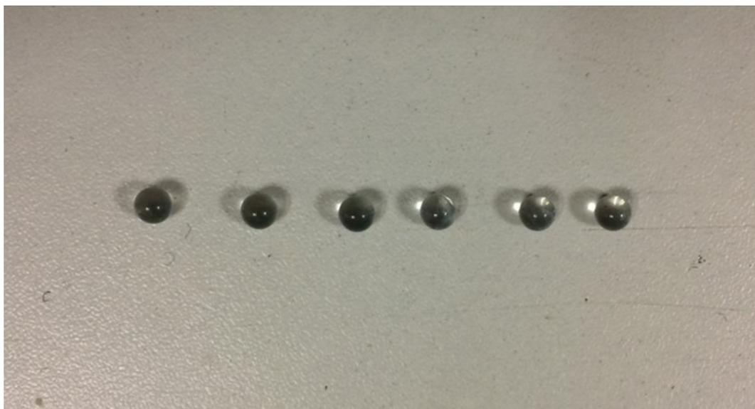
**Figure A.1** – Photographie des billes sodocalciques Preciball de 4 mm de diamètre.
