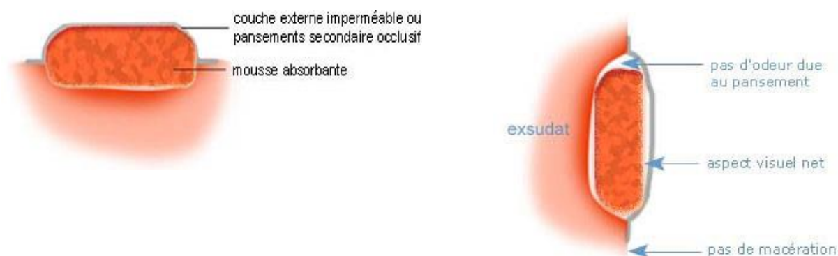
Fig 27 et 28. Schémas de composition et de fonctionnement du pansement hydrocellulaire
