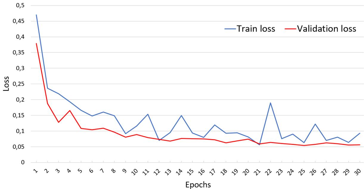
Figure 12 : Fonction de coût sur le set d'entraînement (Train loss) et de validation (Validation loss) au cours de différents epochs pour l'entraînement avec les paramètres suivants : kernel : 5x5,  $\alpha = 0,5$ , seed = 452669
