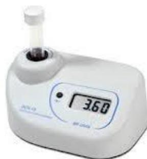
Figure 7 : Densitomètre.
