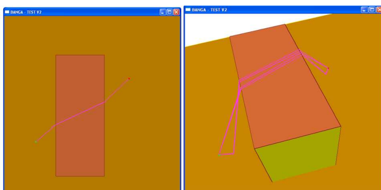
FIGURE 3.8 – Trajet avec résolution de la TGD : 4 trajets (diffraction, sol+diffraction, diffraction+sol, sol+diffraction+sol)
