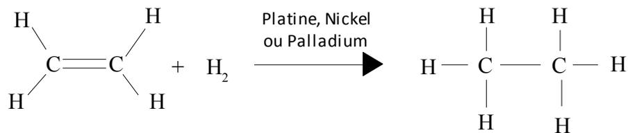
Figure n°19 : Réaction d'hydrogénation de l'éthylène en éthane (d'après McMURRY)
