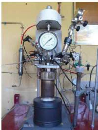
**Figure III-I** Montage réactionnel de liquéfaction
