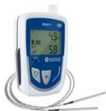
Enregistreur équipée de 2 sondes
