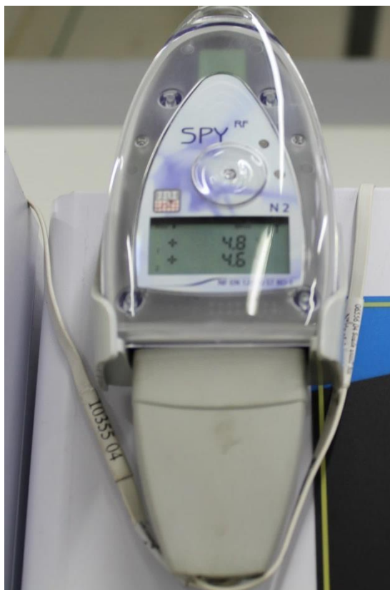
Figure 4 : Sonde et capteur d'enregistrement des températures
