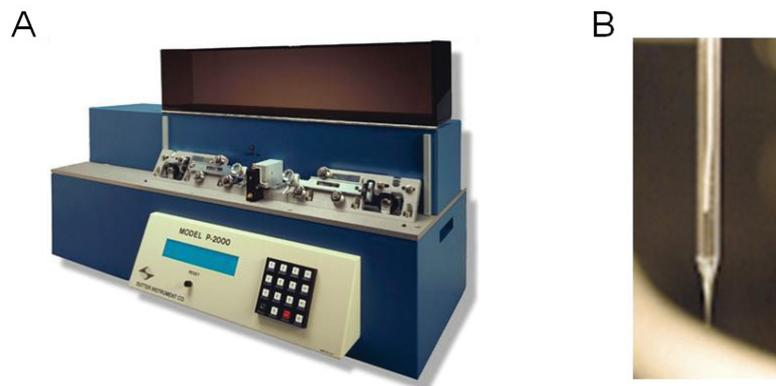
**Figure MM-4 : Obtention des micropipettes nécessaires à la microscopie de conductance ionique à balayage.** A : Etireuse laser modèle P-2000. B : Micropipette obtenue à partir d'un capillaire de borosilicate.
