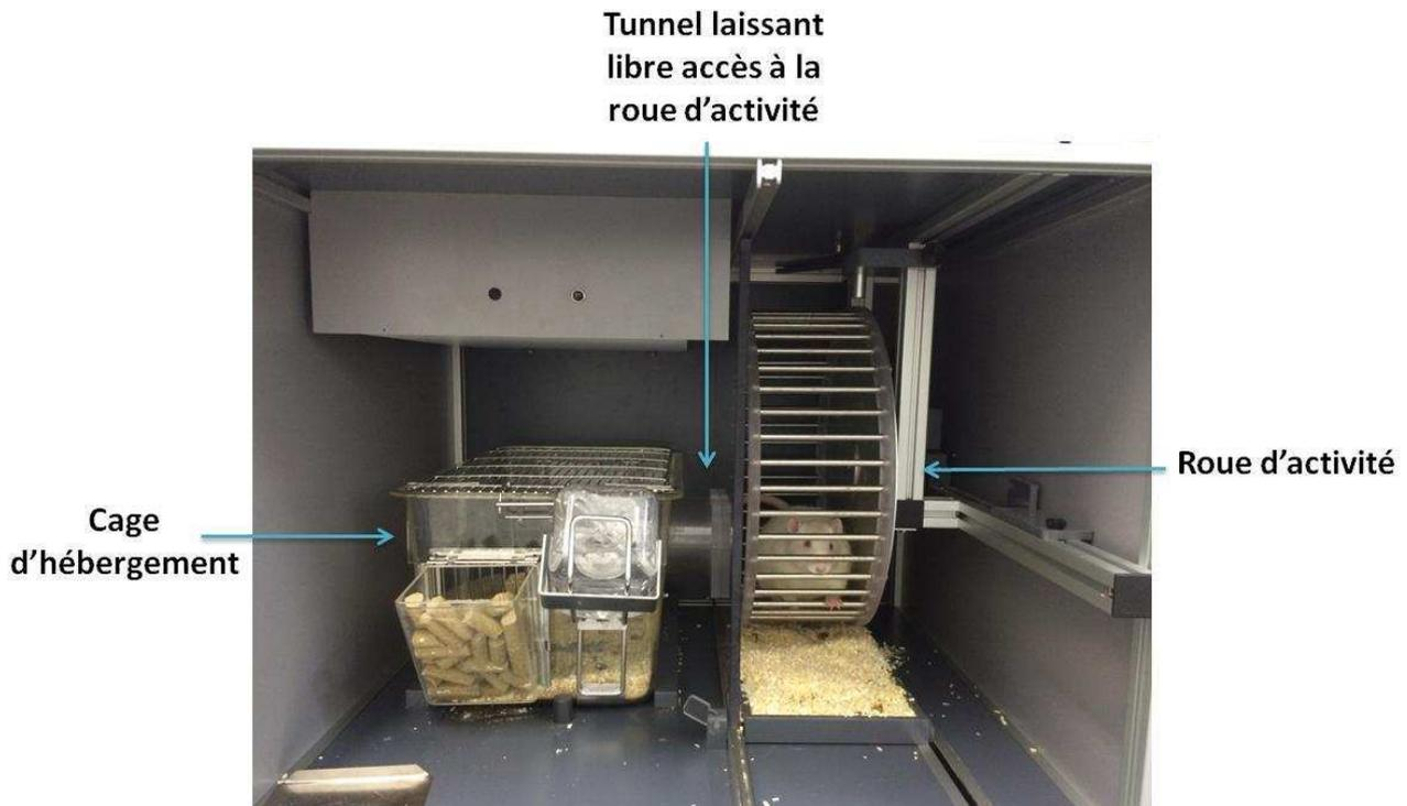
**Figure 16 : Photo du dispositif expérimental utilisé pour le sevrage avec libre accès à une roue d'activité. Les animaux ont une cage d'hébergement leur donnant libre accès, *via* un tunnel, à une roue d'activité fonctionnelle ou bloquée.**
