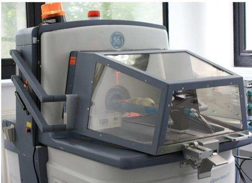
Figure 15 : Photographie du dispositif de la caméra microTEP utilisée.
