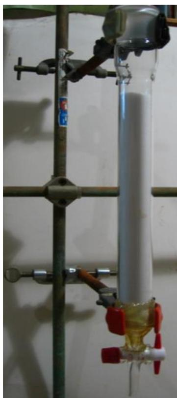
*Figure 9 : Colonne de gel de silice*
