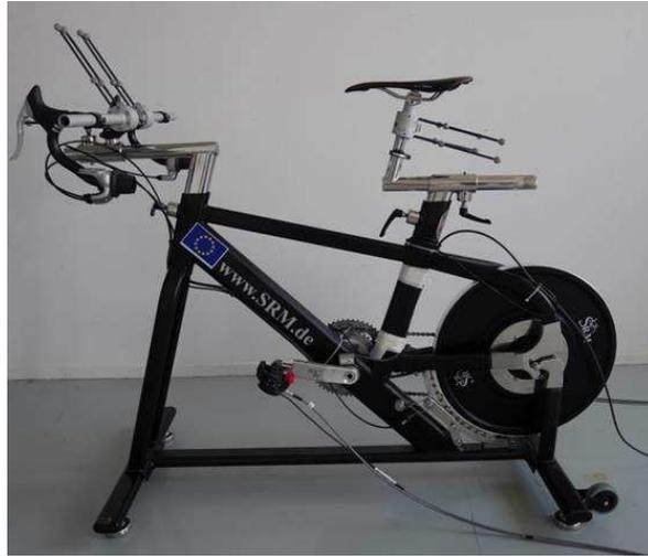
Figure 22 Illustration de l'ergocycle instrumenté en capteurs de forces/moments intégrés au cintre, aux pédales et à la selle utilisée lors de l'expérimentation. Les capteurs sont détaillés au paragraphe II.2.2.
