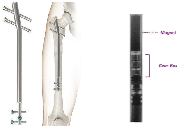
Figure 18 : Clou d'allongement PRECICE (à gauche) ; composition interne du clou (à droite)
