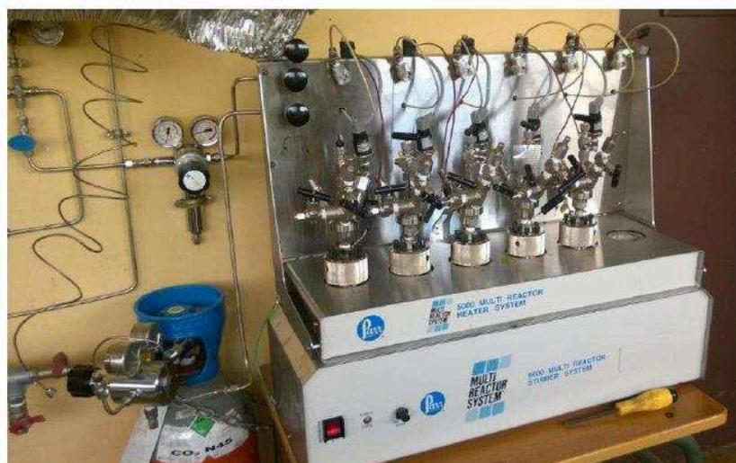
Figure 2-12 : Vue d'ensemble du montage pour l'hydrogénation du furfural
