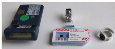
De gauche à droite : dosimètre actif, dosimètre passif corps entier, dosimètre passif extrémités
