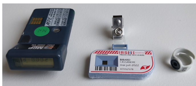
Figure 5 : De gauche à droite : dosimètre actif, dosimètre passif corps entier, dosimètre passif extrémités
