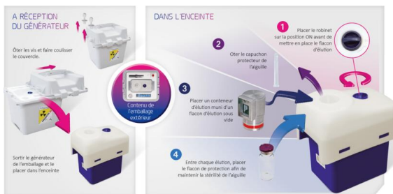
Réception et mise en place d'un générateur de ^{99}\text{Mo}/^{99\text{m}}\text{Tc}
