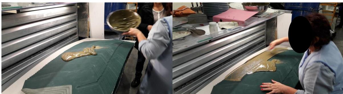
**Figure 5 :** L'opératrice au poste d'encollage verse la colle résultant du mélange Solane Heptane / caoutchouc sur les feuilles découpées et l'étale.
