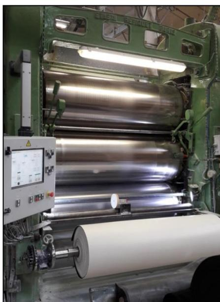
**Figure 2 :** Les calandres entre les rouleaux desquels la matière sortant du mélangeur passe pour être aplatie et chauffée.
