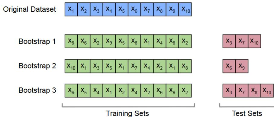
FIGURE 17 - ILLUSTRATION DE LA TECHNIQUE LEAVE-ONE-OUT BOOTSTRAP (LOOB)
