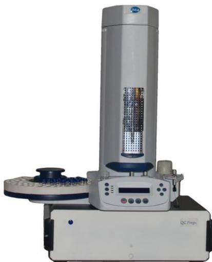
*Figure 6 : Injecteur automatique du système QC-Prep+*
