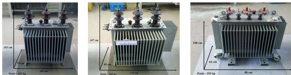
Figure 2.33 : Illustration des transformateurs (de la gauche vers la droite: 100 kVA H61, 160 kVA H61, 160 kVA H59)
