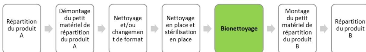
Figure 11 : Cycle de production incluant l'étape de bionettoyage dans le cas des petites et moyennes séries
