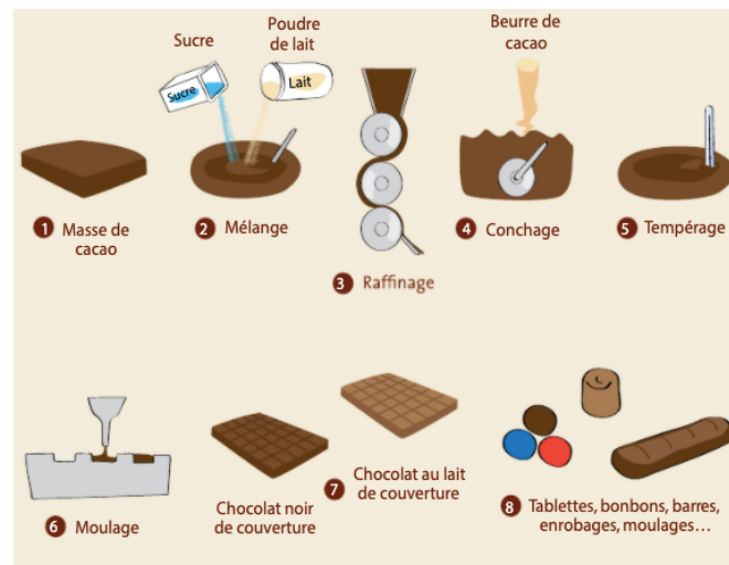
Figure 21 : Schéma de la fabrication du chocolat [14]
