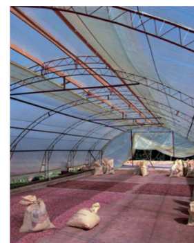
Figure 20 : Séchoir à toit mobile, République dominicaine [14]
