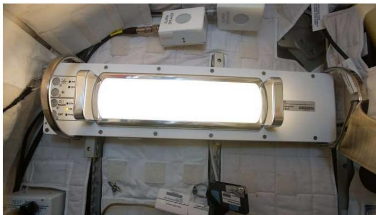
Figure 26 : Dispositif SSLA équipant la station spatiale internationale (101)
