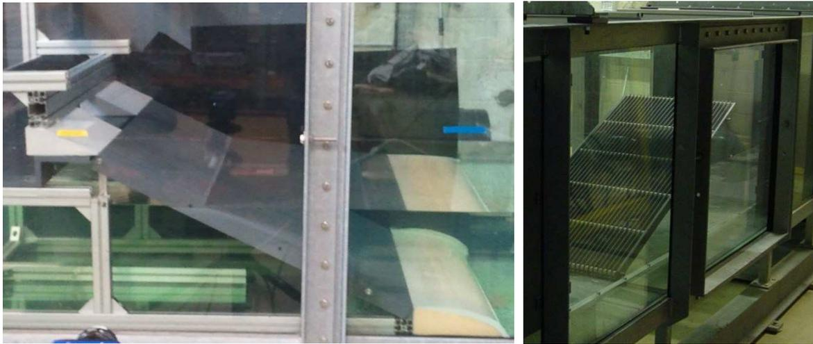
Figure II-7 : A gauche, une grille inclinée à  $25^\circ$  dans le canal en pleine largeur lors d'une étude sur les exutoires (configuration avec un exutoire positionné au centre du canal). Le pied de la grille est posé sur le sol et le haut de la grille est maintenu par deux broches fixées sur une structure en Norcan. A droite, une grille inclinée dans le canal réduit. Le bas de la grille peut pivoter et le haut de la grille est vissé dans les parois.
