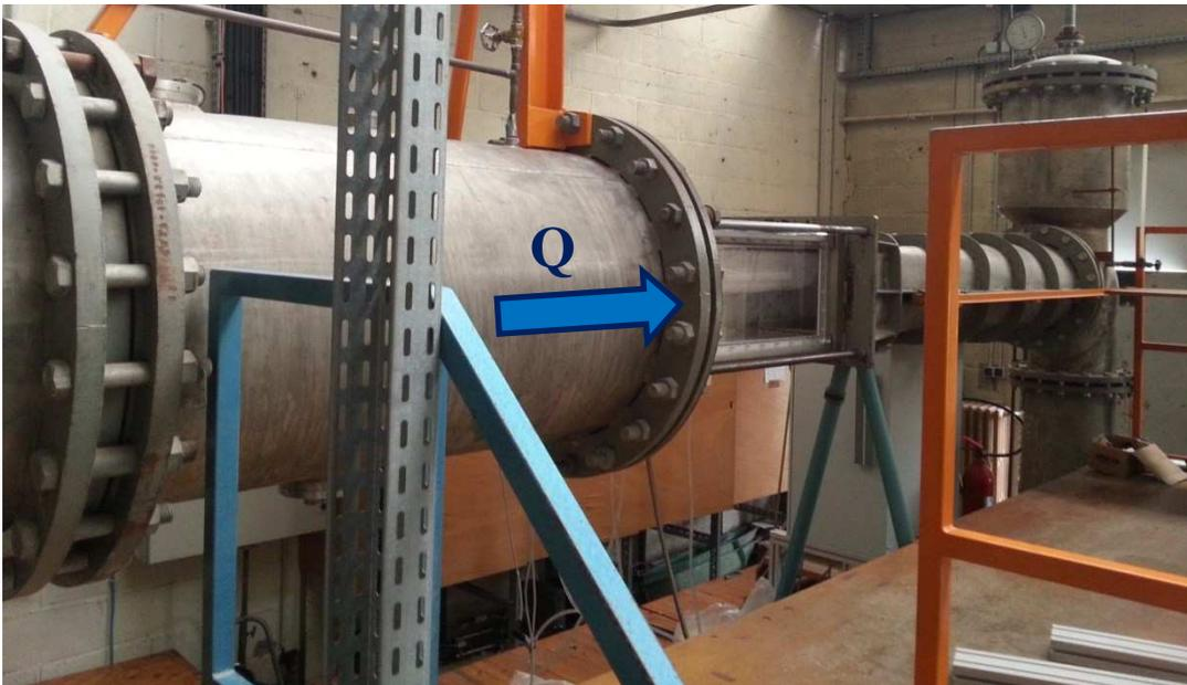
Figure II-21 : Partie haute de la veine hydraulique avec le tronçon transparent au centre.
