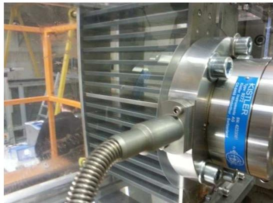
Figure II-23 : Grille complète insérée dans la veine hydrodynamique. Le barreau central, relié à la balance, est ici entouré de 14 barreaux disposés de part et d'autre ( $e = 10$  mm).
