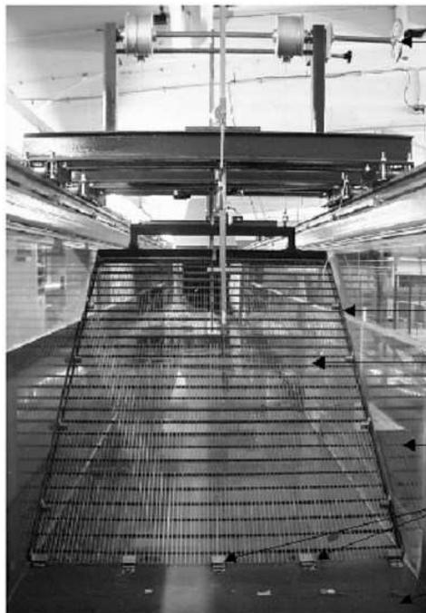
Figure I-7 : Photo des grilles inclinées possédant un maillage très fin (wedge wire screen) utilisés par Reuter et al. (2001) (source : Reuter et al. (2001)).
