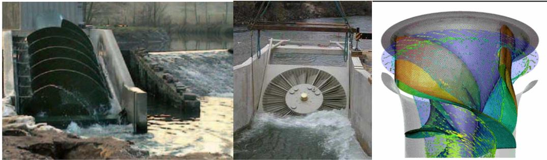
Figure I-2 : De gauche à droite : Photo d'une vis hydrodynamique (source Ritz-Atro), d'une turbine VLH (source MJ2 Technologies) et simulation numérique d'une turbine Alden (source Alden Lab).
