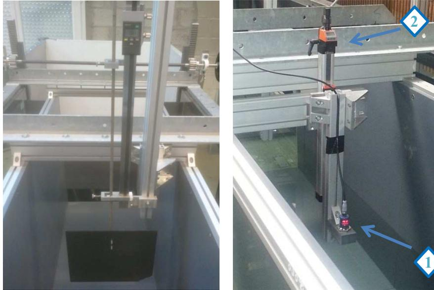
Figure II-14 : A gauche, une pelle fixée sur une bande magnétique. A droite, le capteur acoustique (1) fixé sur la réglette verticale (2).
