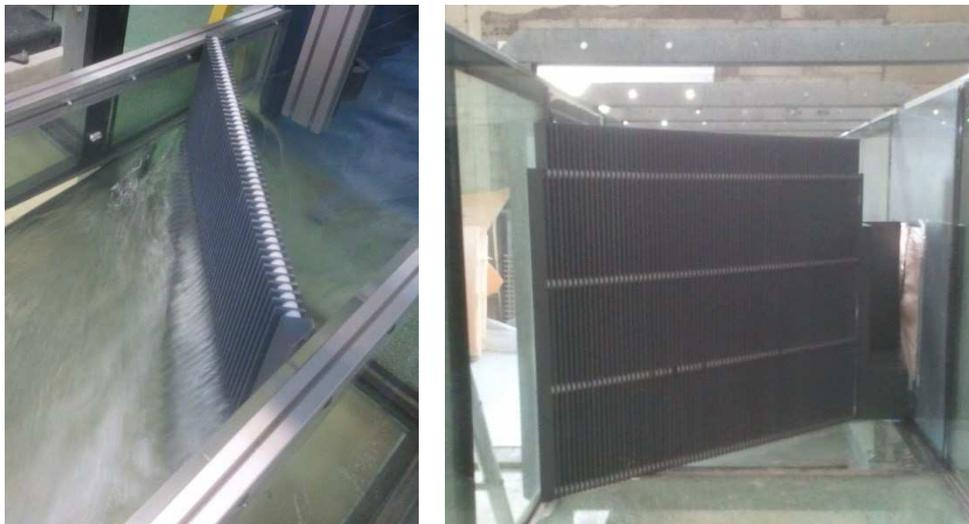
Figure II-9 : A gauche, une grille orientée à  $\alpha = 45^\circ$  dans le canal réduit vue depuis l'aval. A droite, une grille orientée à  $\alpha = 45^\circ$  dans le canal de pleine largeur avec un exutoire en fin de grille (grille vue depuis l'amont).
