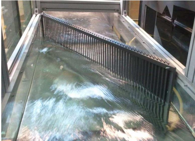
Figure II-10 : Photo d'une grille GOBSE orientée à  $\alpha = 30^\circ$  vue depuis l'amont.
