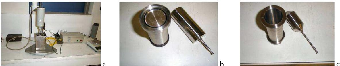
Fig 2.15 : Rhéomat 15T du DAAP (a) ensemble du système (b) cylindres MS-O (c) cylindres MS-A
