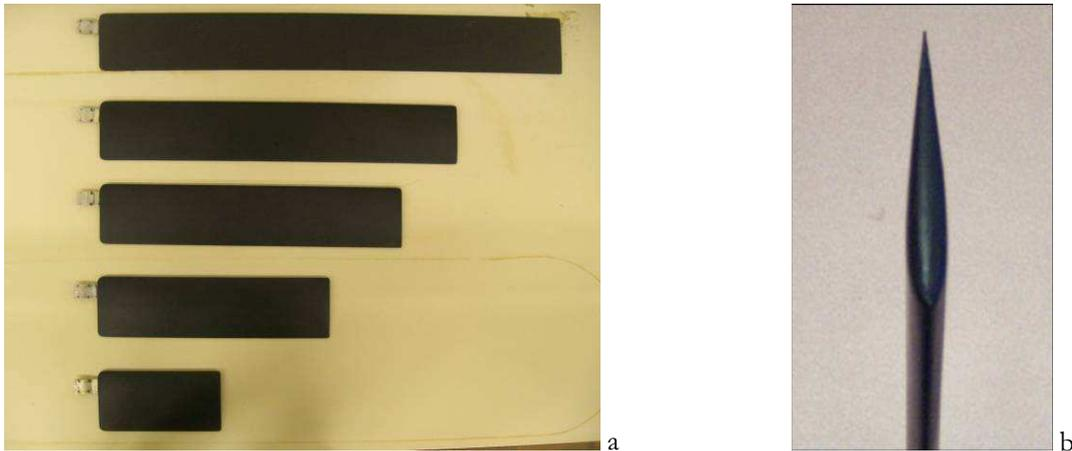
Fig 2.8 : (a) Profils NACA 0012 d'allongement variable (b) Détail de la forme des profils
