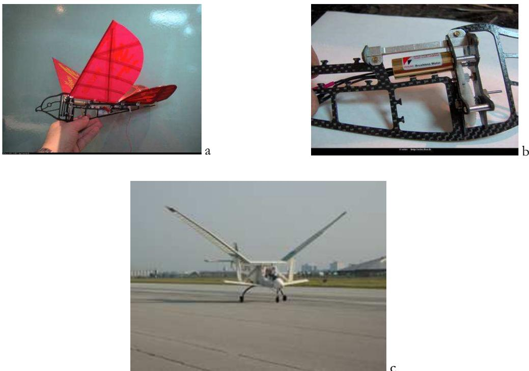
Fig. 1.2 : Réalisations d'ornithoptères imitant les oiseaux : (a) vue d'ensemble du Wingbird (b) détails du mécanisme d'actionnement des ailes du Wingbird (c) ornithoptère de [De Laurier \[59\]](#)
