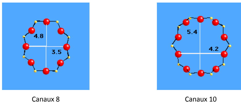
Figure I-12 : Canaux de la Ferrierite [91].
