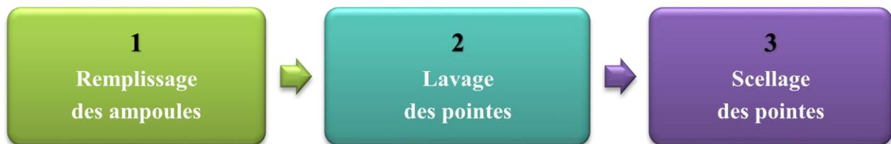
Figure 10 – Chronologie de la fabrication des ampoules buvables
