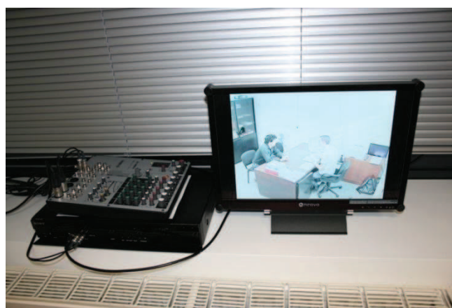
Figure 2 : photo du matériel en fonctionnement. A gauche, enregistreur numérique et table de mixage. A droite, écran. Cette image ne montre pas les hauts parleurs situés de part et d'autre de l'installation.
