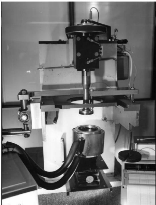
*Figure 4.1. : Tribomètre pion-disque*
