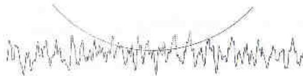
Figure 1.16 : Contact entre une sphère et un plan rugueux (Source Greenwood et Tripp [64])
