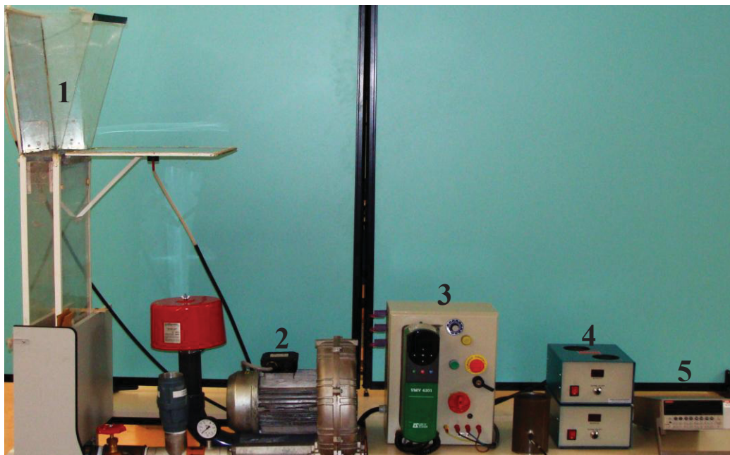
Figure 3.4 : Banc expérimental pour l'étude de la charge des mélanges binaires des matériaux plastiques dans un dispositif de triboélectrisation à débit moyen et électrodes inclinées ; 1- dispositif pré-pilote industriel à débit moyen et électrodes inclinées, 2- soufflante, 3- variateur de fréquence, 4- sources haute tension, 5- électromètre Keithley.
