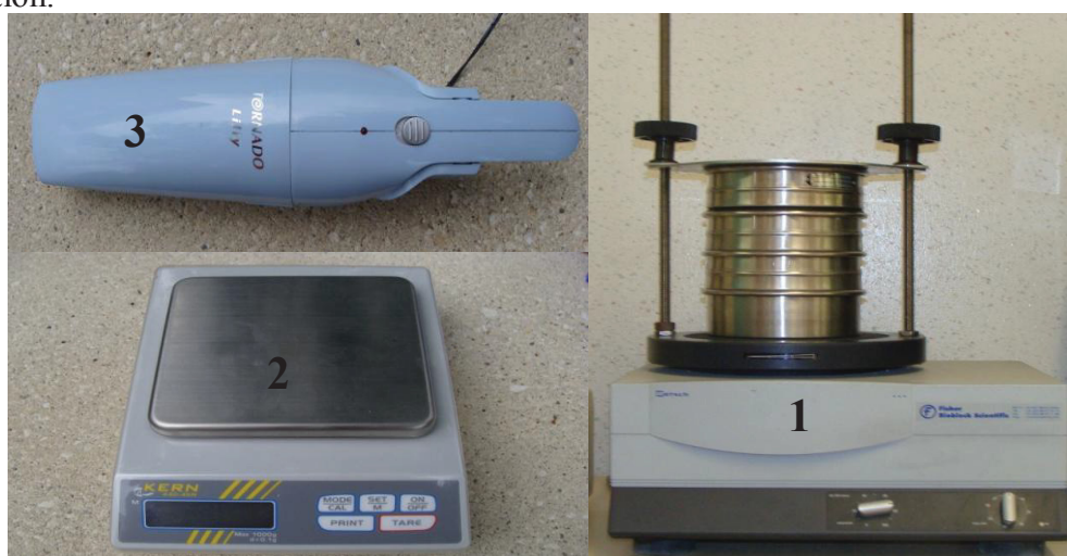
Figure 3.13 : Équipements auxiliaires utilisés dans les expériences de triboélectrisation : 1) tamiseuse, 2-balance électronique (précision 0.01 g), 3-aspirateur
