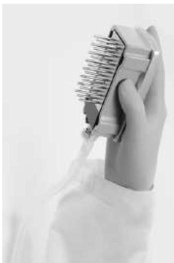
Figure 13: Illustration du système d'aspiration « hérisson » (Manuel du kit therascreen KRAS 12-13, KRAS 61 Pyro 07/2011)
