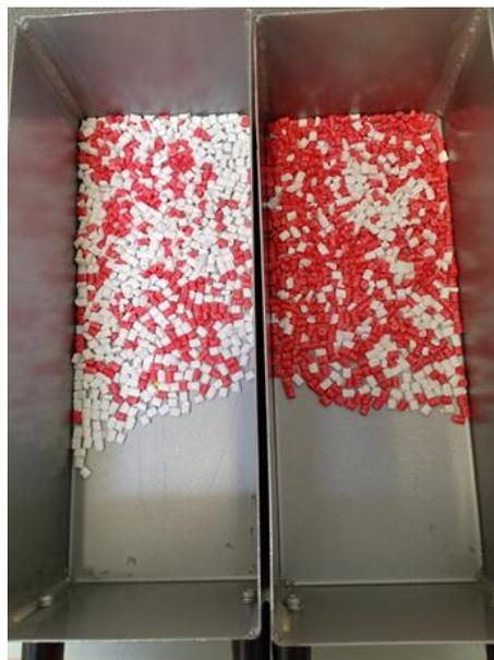
**Figure V.8.** Résultats de séparation du mélange PP bromé et PP non-bromé. (Parois en PS,  $t = 5 \text{ min}$ ,
