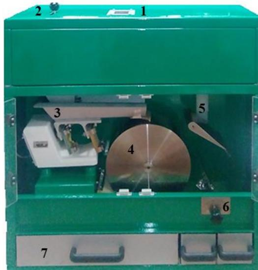
**Figure II.12.** Photographie de l'installation de séparation : (1) trémie d'alimentation du chargeur ; (2) système d'ouverture/fermeture de la trappe du chargeur ; (3) goulotte oscillante ; (4) électrode cylindrique tournante reliée à la terre ; (5) électrode statique reliée à une source de haute tension ; (6) système de réglage de l'inclinaison du volet déflecteur ; (7) collecteurs à trois compartiments.
