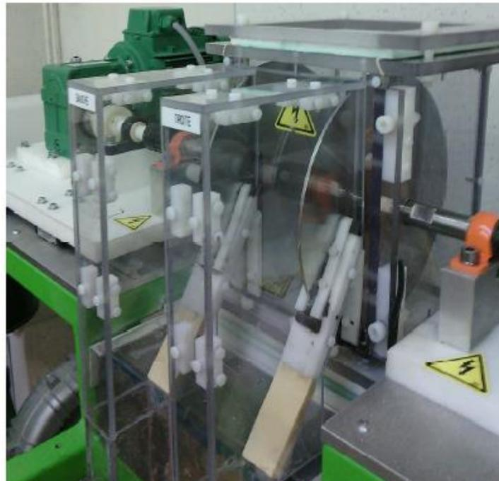
**Figure I.19.** Photographie du dispositif tribo-aéro-électrostatique à disques tournants.
