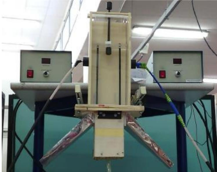
Figure I.20. Photographie du dispositif de triboélectricité à électrodes verticales.
