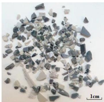
**Figure III.8.** Tailles et formes du mélange PC-ABS / PVC obtenu après broyage (Diamètre des mailles de la grille = 5 mm).
