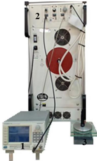
**Figure II.7.** *Système d'alimentation électrique de la cellule de DBD : (1) générateur de fonction ;(2) amplificateur haute tension (3) cellule de DBD.*
