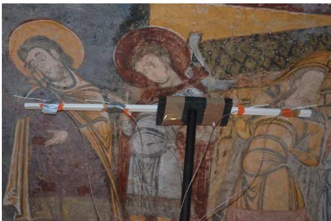
Figure 265: Instrumentation de la fissure. Les premiers capteurs sont placés à l'intérieur de la baguette blanche.
