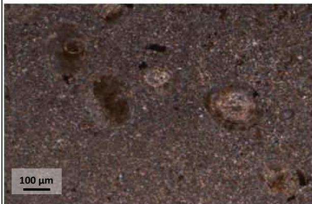
Figure 73 : Calcaire du Ricou hétérogène (RLH), détail, lumière polarisée
