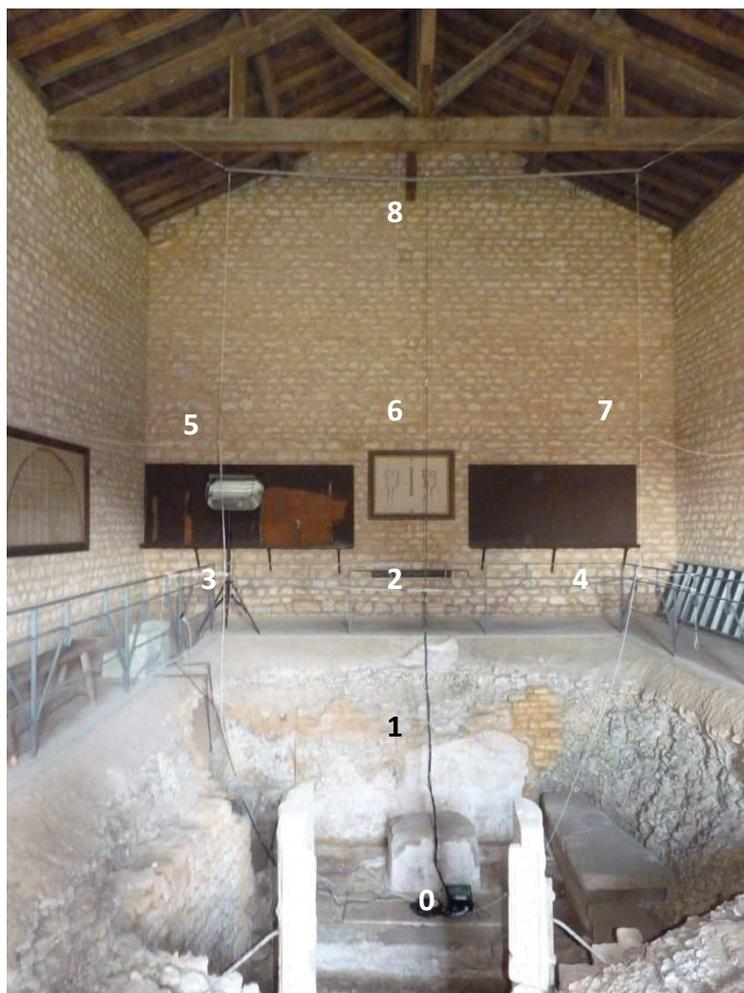
Figure 210 : Panneau central. Les câbles ne touchent aucune maçonnerie historique. Ce panneau est composé de 9 thermo hygromètres (M<sub>0</sub> à M<sub>8</sub>).
