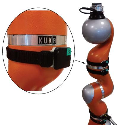
FIGURE 10.1 – Bras robotisé à sept degrés de liberté équipé de capteurs inertiels
