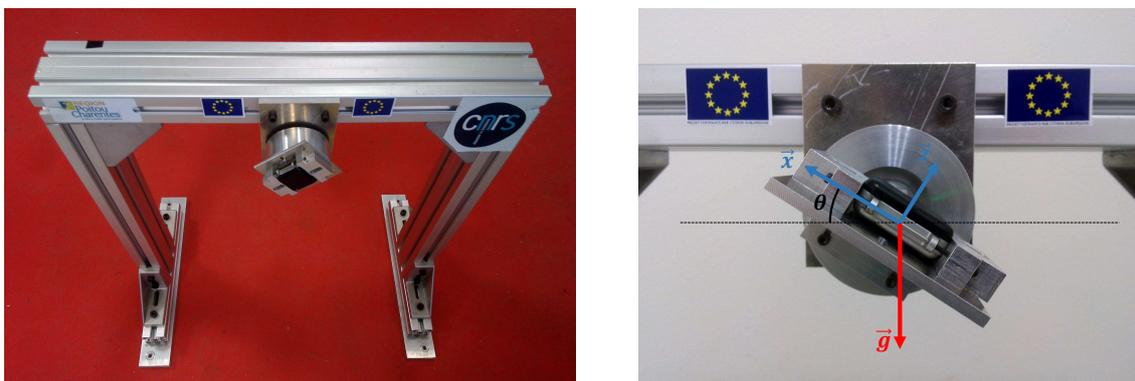
FIGURE 3.1 – Banc d'essai motorisé équipé d'un capteur APDM Opal
