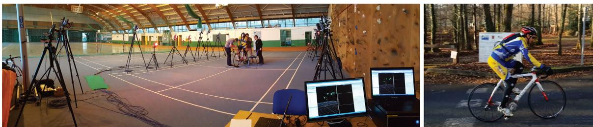
FIGURE 10.2 – Expérimentation de validation de la mesure inertielle ambulatoire dans le cadre d’un mouvement de pédalage
