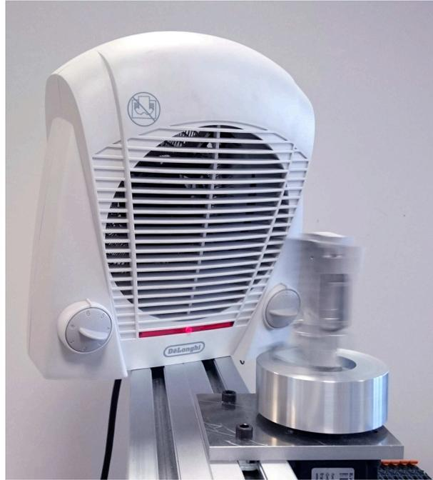
FIGURE 4.3 – Chauffage d’appoint placé à proximité du capteur dont la vitesse de rotation est imposée par le banc motorisé
