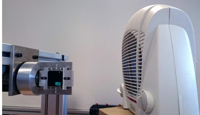
FIGURE 3.10 – Chauffage d'appoint placé à proximité du capteur dont l'orientation est imposée par le banc motorisé
