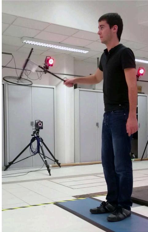
FIGURE 7.3 – Application des mouvements de l'équerre à la main, dans le champs de mesure du système optoélectronique
