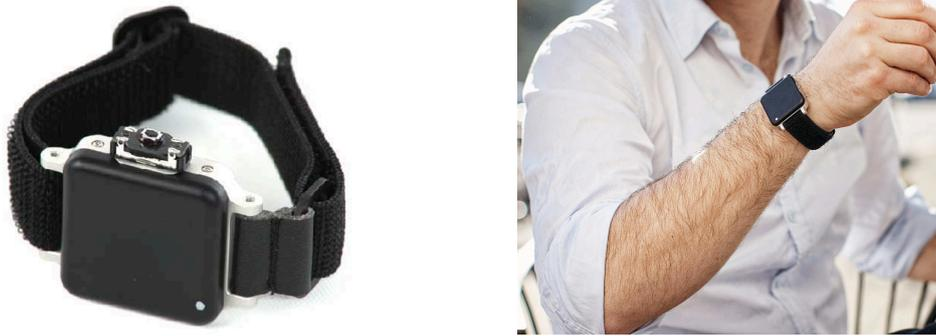
FIGURE 2.1 – Capteur inertiel APDM Opal destiné à l'analyse du mouvement humain
