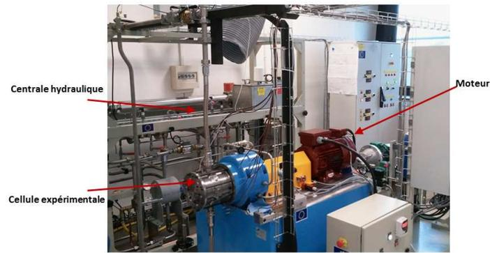
FIGURE 4.1 – Dispositif expérimental
